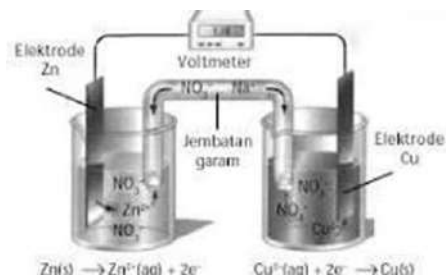
Gambar 8.1. Sel Volta (Sumber: Chang, R. 2004)
