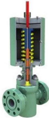
Gambar 4.8. Aktuator Piston Pneumatik (Sumber : (Elga Aris Prastyo, 2022b))
