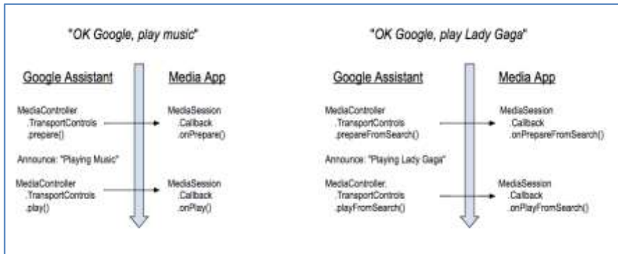
Gambar 6.4. Diagram urutan panggilan yang dihasilkan oleh Google Asisten dan callback sesi media yang terkait. (Sumber : developer.android.com)
