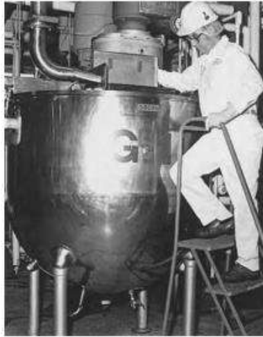
Gambar 2. 11. Alat pencampuran dalam pembuatan salep dan krim (Allen & Ansel, 2014)
