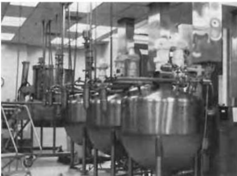
Gambar 2. 2. Bejana pencampur untuk pembuatan sediaan larutan skala besar di industri farmasi (Allen & Ansel, 2014)
