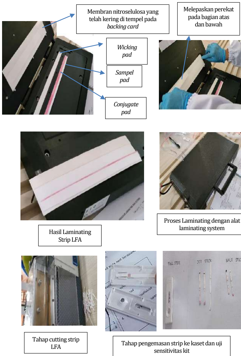
Gambar 4.7. Tahapan Laminating, Cutting, Pengemasan dan Uji kit LFA (Sumber: Pribadi).
