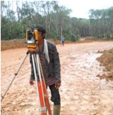
Gambar 2.3. Survey pengukuran dengan alat theodolit digital Sumber : kumpulengineer.com
