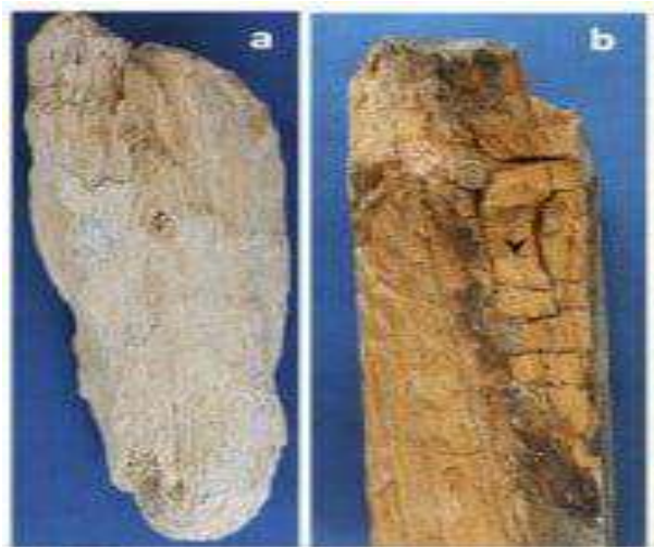
Gambar 11.9. Deteriorasi kayu karena jamur. (a) sepotong kayu yang terkena busuk putih, (b) sepotong kayu terkena jamur busuk coklat
