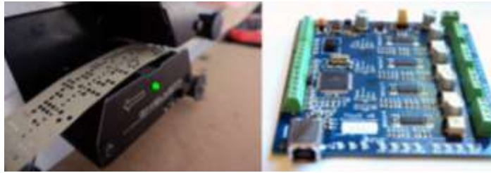
Gambar 7.1. a) Pita Berlubang pada NC. b) Microcontroller pada CNS. Sumber : mellowpine.com/cnc/numerical-control
