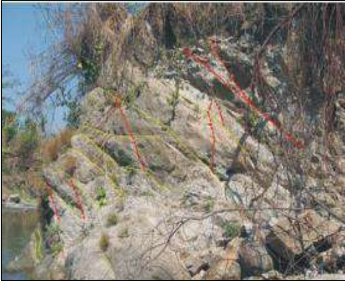
Gambar 4.2. Singkapan di tepian Sungai Kaligarang memperlihatkan keberadaan bidang sesar yang memotong perlapisan batupasir tufan, ditandai dengan garis kuning (Poedjoprajitno, Wahyudiono, & Cita, 2008)
