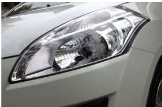
Gambar 3.1 : Reflektor lampu kendaraan menggunakan cermin cekung
