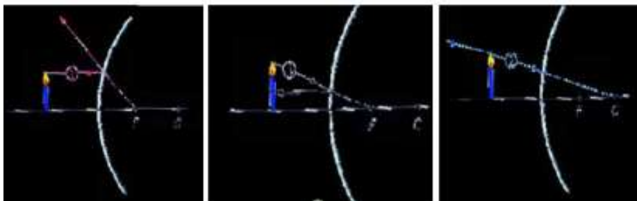
Gambar 4.14 : Tiga Sinar Istimewa Pada Cermin Cembung
