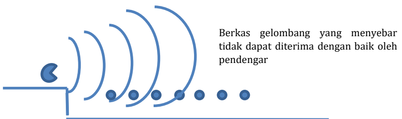
Gambar 3. 4 Skema Penyebaran Bunyi pada Ruang Terbuka
