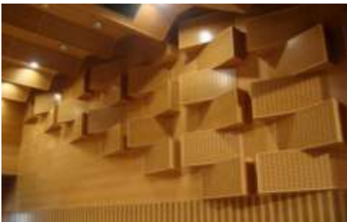
Gambar 3. 15 Contoh Difuser pada dinding dan plafon auditorium
