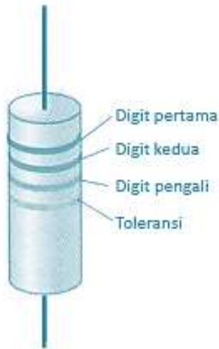
Gambar 8.6. Kode warna pada hambatan
