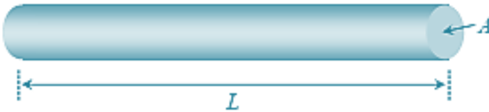
Gambar 8.5. Faktor pada kawat yang menentukan hambatan listrik yang dimiliki kawat tersebut.
