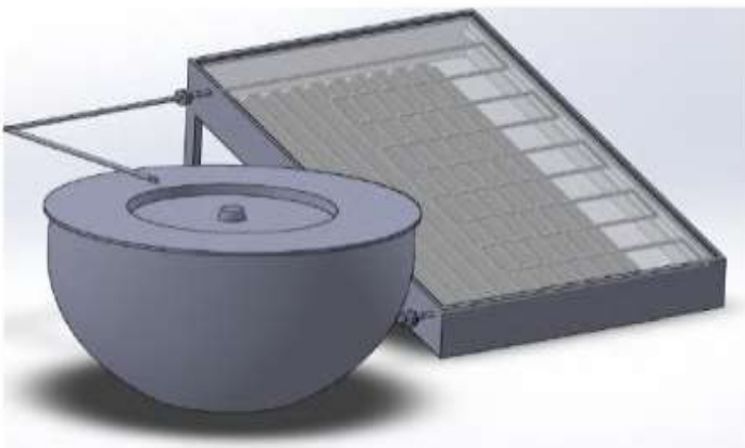
Gambar 4. 2 Pemanas Air Tenaga Surya Sederhana (Sumber : (Renaldo Maxillion Parinussa 2016))
