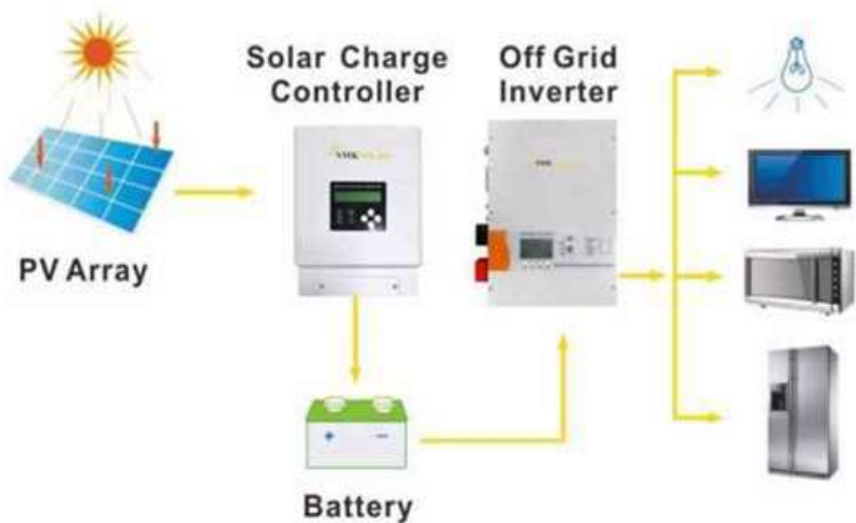
Gambar 4. 1 Skema Proses Pemanfaatan Energi Surya (Sumber : (Samsulrizal 2021))
