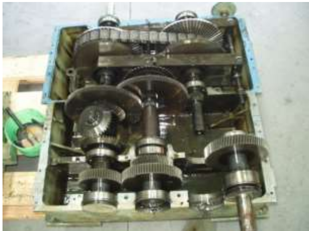
Gambar 5.8. PIV Laminated chain terpasang di dalam gearbox .
