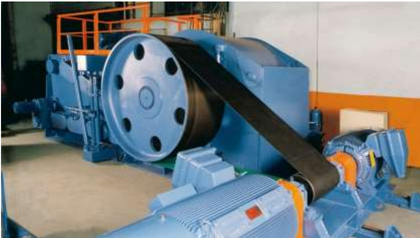
Gambar 5.30. Aplikasi flat belt untuk transmisi / pemindah daya
