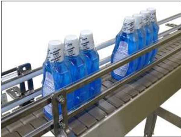
Gambar 5.9. Table top chain (TTC) untuk aplikasi conveyor packaging.
