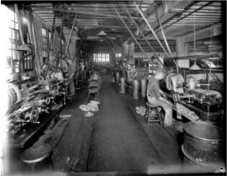
Gambar 5.27. Sebuah bengkel mesin menggunakan 1 poros penggerak utama kemudian diteruskan menggunakan transmisi sabuk ke masing-masing mesin. (Sumber : https://emke.uwm.edu/ )
