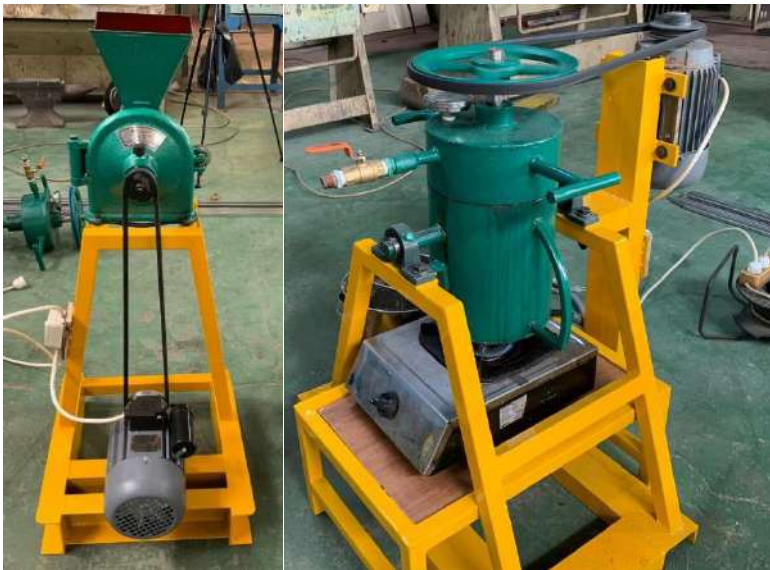
Gambar 4. 2. Alat Hidrothermal pengolah popok
