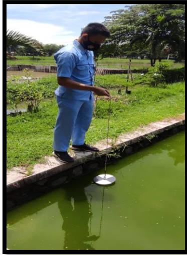
Gambar 4.2. Pengukuran Kecerahan menggunakan secchi disk
