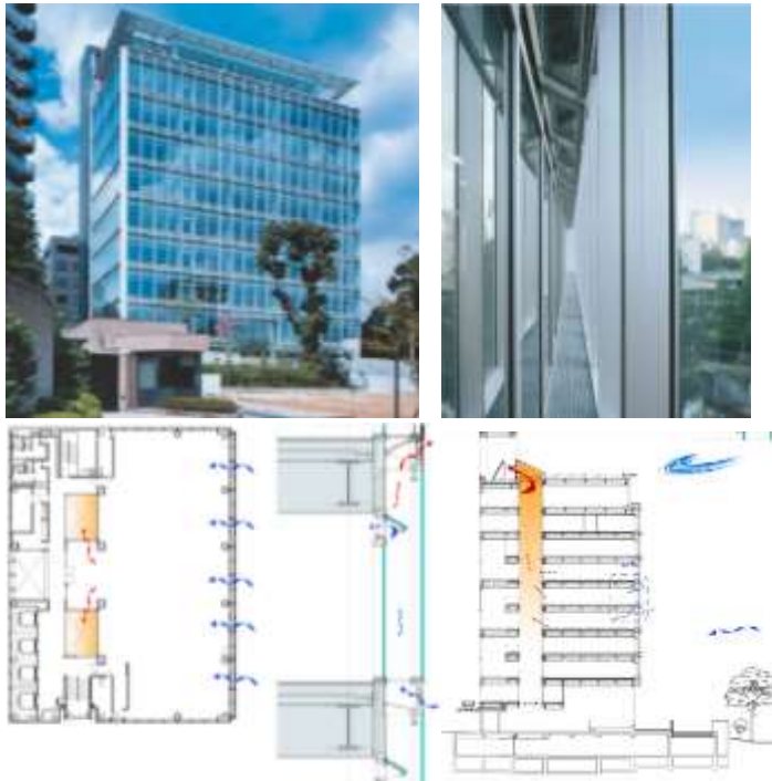
Gambar 2. 28. Konsep kulit ganda dan ventilasi alami gedung Sekisui Office Towers di Tokyo-Jepang
