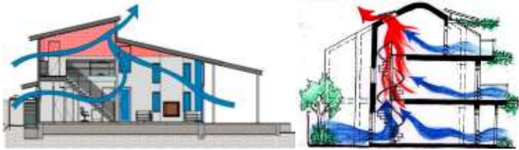
Gambar 2. 38. Stack ventilation pada bangunan atap miring Sumber: (Sukawi et al, 2013)
