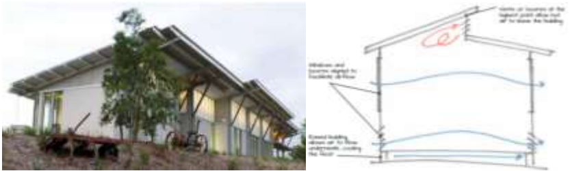
Gambar 2. 34. Ventilasi silang pada bangunan Sumber: (CRC, 2011)
