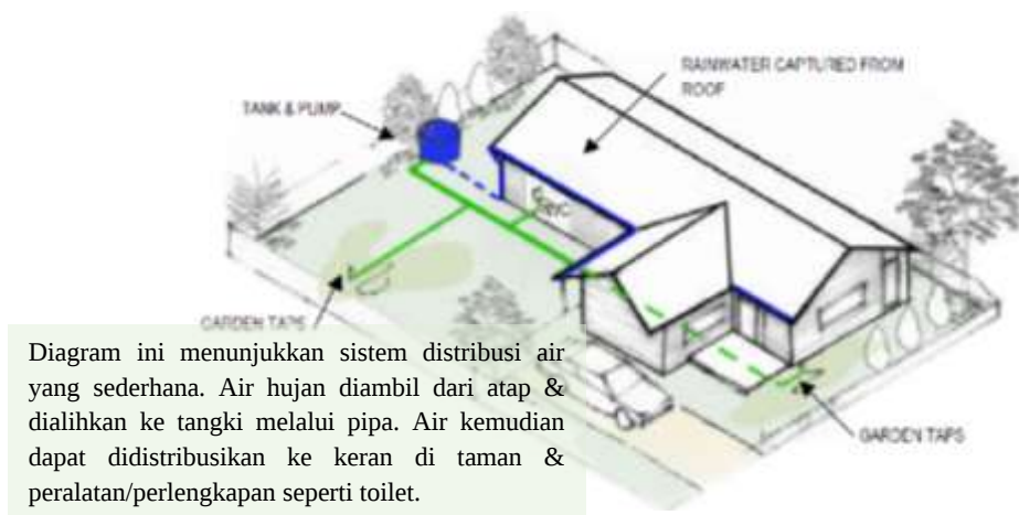
Gambar 3. 26. Sistem distribusi air hujan
