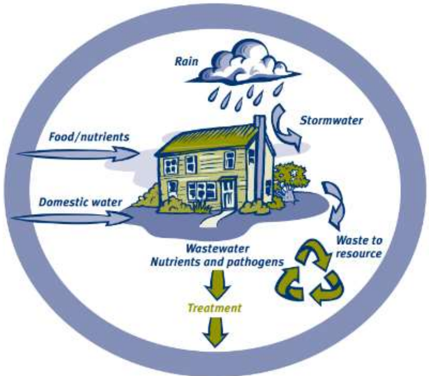
Gambar 3. 19. Sistem air limbah domestik Sumber: (Ferguson & Dakers, 2003)
