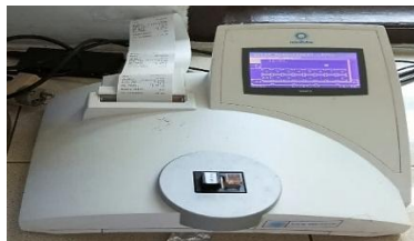
Gambar 3. 1 Photometer SDM6 untuk Menganalisis Konsentrasi Sel Sperma dan Menghitung Jumlah Volume Pengencer Secara Otomatis
