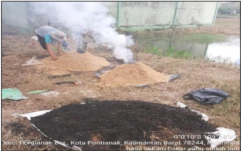
Gambar 4. 1. Proses Pembuatan Biochar Sekam Padi (Suryani dan Sutikarini, 2021)
