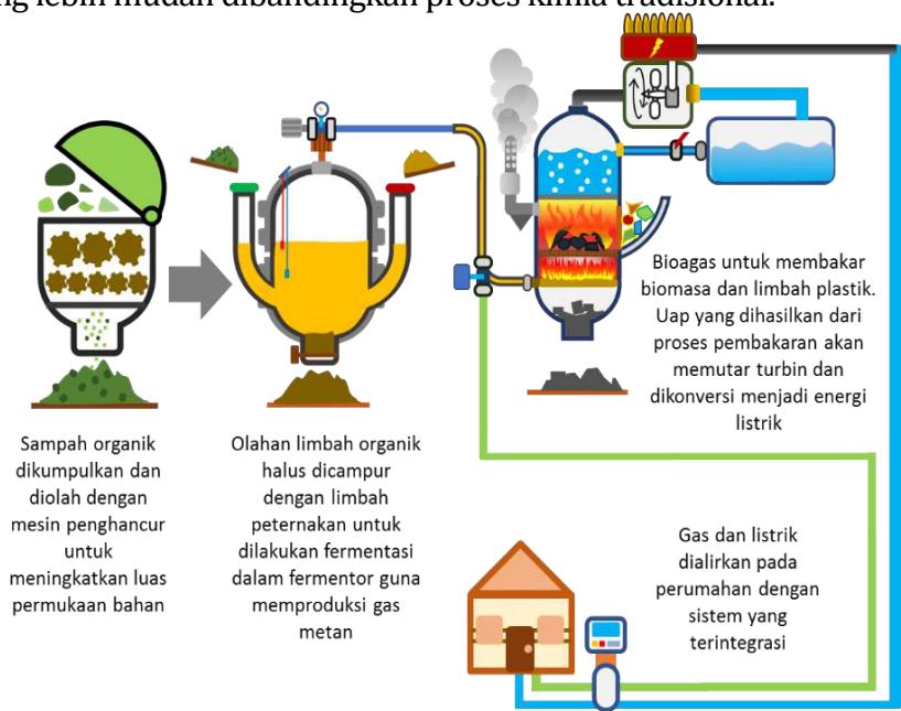
Gambar 5.1. Ilustrasi skematis rancangan proses pemanfaatan dan konversi bioenergi terintegrasi.
