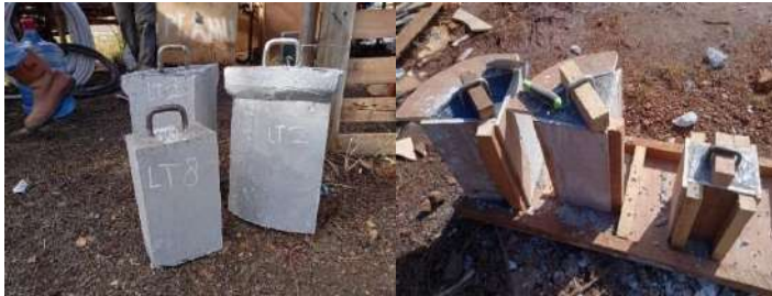
Gambar 3. 9. Pembuatan Batu bata tahan api dengan metode casting
