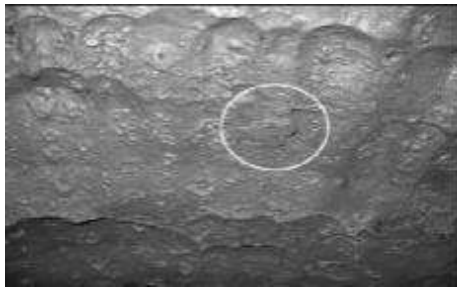
Gambar 3. 4. Penutupan Refraktori oleh slag
