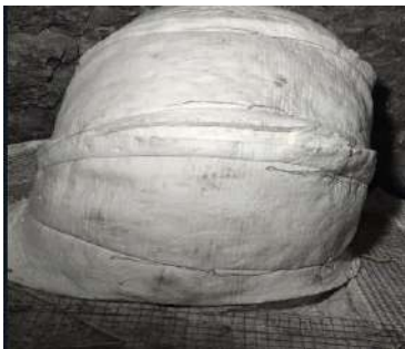
Gambar 5. 10. Gambar ( a ) Salah satu pengaplikasian blanket untuk melindungi tools atau material dari panas yang berlebih. Gambar (b) pengaplikasian blanket untuk terhindar dari heat loss yaitu menutup lubang keluaran .
