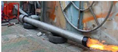
Gambar 5. 7. Salah satu contoh burner yang sudah di modifikasi sesuai dengan kebutuhan lapangan
