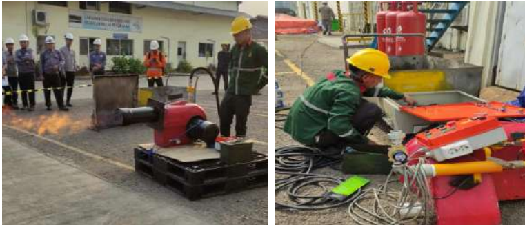
Gambar 5. 11. Pengetesan burner dan pengecekan kelengkapan tools burner
