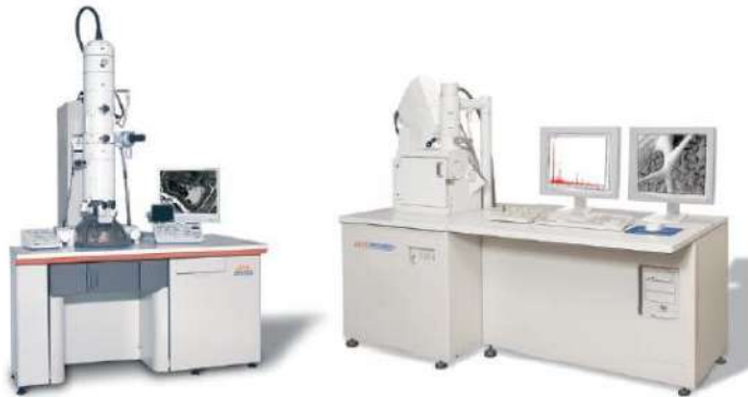
Gambar 4.10. Mikroskop Elektron; TEM (kiri) dan SEM (Kanan) (Sumber Alponsin, 2019)
