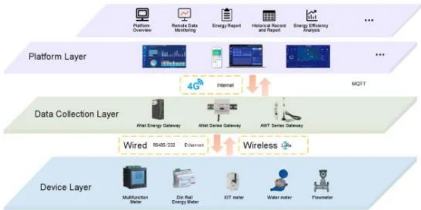
Gambar 3. 8 Skema Layer yang Menunjukkan Cara Kerja Real-Time Monitoring System
