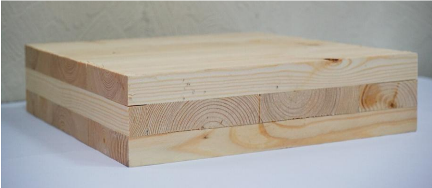
Gambar 4.1. Kayu Laminasi Silang, material yang sering digunakan pada bangunan NZEB (Sumber: (Wikipedia contributors, 2025))
