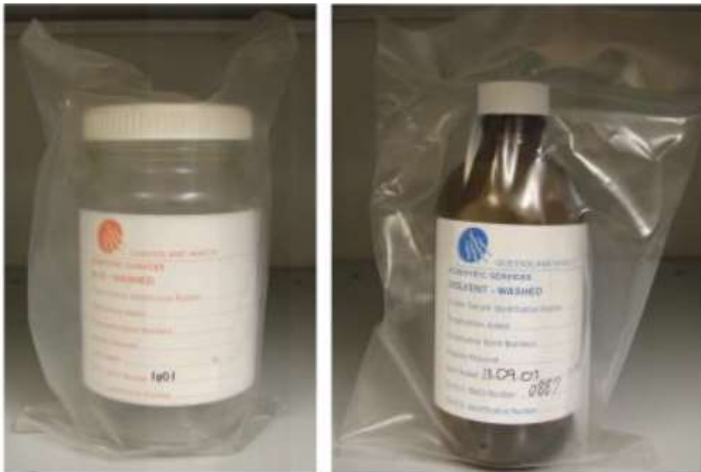
Gambar 6.6. Contoh pengemasan sampel dengan kantong sampel ganda. (Sumber: Queensland Government, 2018)
