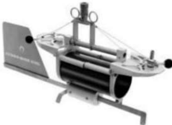
Gambar 4.5. Alat pengambilan sampel air tipe kedalaman terpadu
