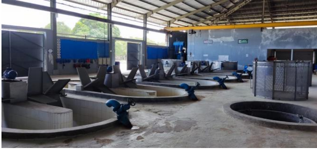
Gambar 23. Peralatan yang Digunakan dalam Proses Pengadukan dan Pencucian Rumput Laut
