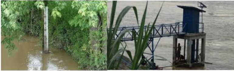
Gambar 7.5. Alat ukur tinggi muka air manual dan AWLR (P3SDA)
