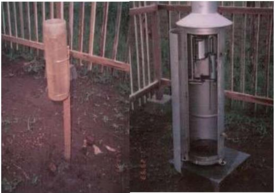
Gambar4. 4. Pengukur hujan manual (kiri); pengukur hujan otomatis (kanan)
