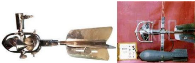
Gambar 7.6. Current meter sumbu tegak (tipe canting) (P3SDA)
